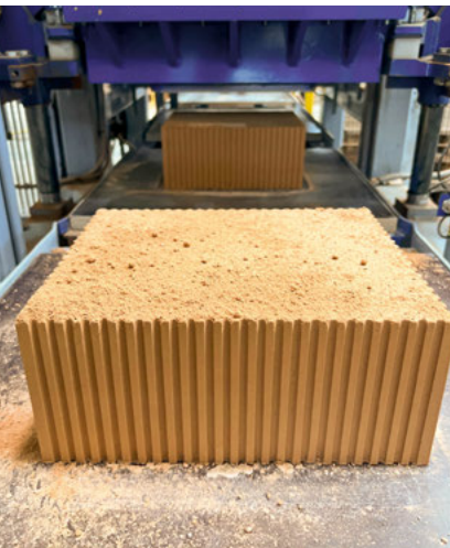
Der Kaltziegel punktet mit guten Schalldämmeigenschaften bei gleichzeitig hoher Tragfähigkeit.
